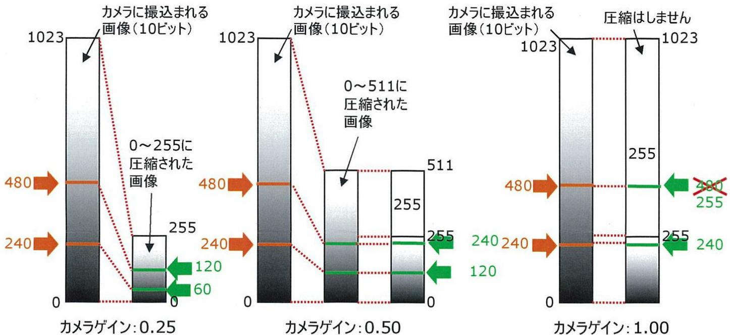
上図左は、カメラゲインが0.25の場合です。カメラには10ビットデータ(0～1023)として蓄えられていますが、これに0.25を掛け算して0～255の8ビットデータに圧縮されます。上図中はカメラゲインが0.50(デフォルト値)の場合です。カメラの10ビットデータは0.5を掛け算して0～511の値に圧縮されます。そのうち0～255はそのまま使用し、256～511の値は8ビットデータの最大値255に置き換える処理を行います。上図右は、カメラゲインが1.00の場合です。カメラの10ビットデータのうち0～255はそのまま使用し、256～1023の値を最大値255に置き換える処理を行います。
