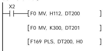
X2がONしている間、Y0からDUTY比10%、300 Hzのパルスが出力されます。その時方向出力(Y2)はOFFし、高速カウンタCH0の経過値(DT9044, DT9045)は加算カウントされます。
