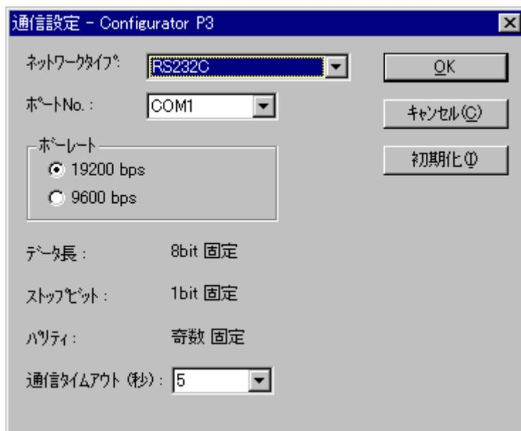
このダイアログボックスに表示されている内容が、パソコンと位置決めユニットの接続条件に合致しているかを確認してください。合致していない場合は正しい通信条件を選んで[OK]ボタンを押してください。
