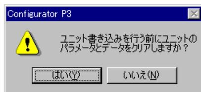
次に[実行]ボタンを押すと、位置決めユニットにパラメータとデータの転送が実行されます。このときに、左図のようなメッセージボックスが表示されたら、[はい]をクリックしてください。
