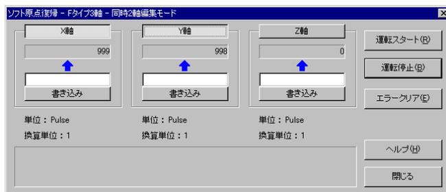
この図のように、X 軸、Y 軸のボタンをクリックして軸を選択すると、[運転スタート]ボタンをクリックできるようになります。
