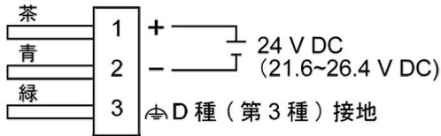
・ノイズの影響を小さくするため、電源線はツイスト処理（より線処理）してください。
