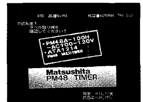
図3: 角度検査例 ワークの傾きを求め表示します。
